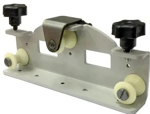
Данное приспособление позволяет продвигать деревянную заготовку вдоль вращающегося пильного диска и обеспечить ровный рез при распиле материала.
