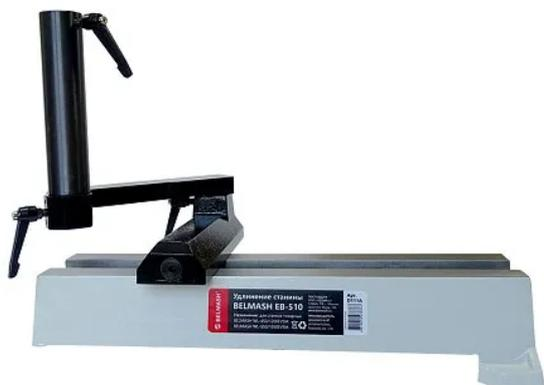
Чугунное удлинение станины с основанием подручника для токарных станков BELMASH WL-450/1200EVSM и BELMASH WL-550/1050EVSM.
