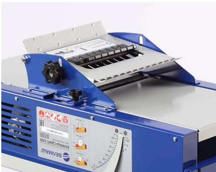
Устройства прижимные предназначены для безопасной обработки при строгании заготовок толщиной менее 63 мм.
