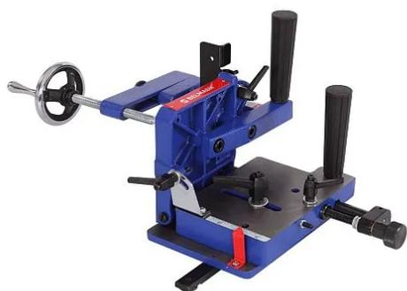
Приспособление шипорезное устанавливается в паз циркулярного станка, заготовка фиксируется вертикально по отношению к станку в различных положениях, что позволяет выполнить угловые пазы шипа. Затем приспособление убирают и заготовку кладут плашмя на циркулярный станок для выполнения заплочиков.
