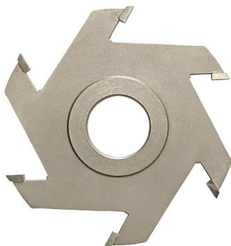
Фреза пазовая (дисковая) BELMASH 125x32x4 мм применяется для выработки прямоугольных пазов, выборке четвертей и фрезеровании вдоль волокон в заготовках из древесины различных пород. Максимальная частота вращения – 6200 об./мин.
