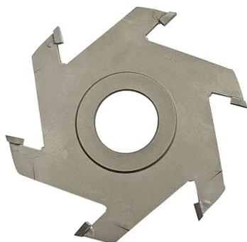
Фреза пазовая (дисковая) BELMASH 125x32x6 мм применяется для выработки прямоугольных пазов, выборке четвертей и фрезеровании вдоль волокон в заготовках из древесины различных пород. Максимальная частота вращения – 6200 об./мин.
