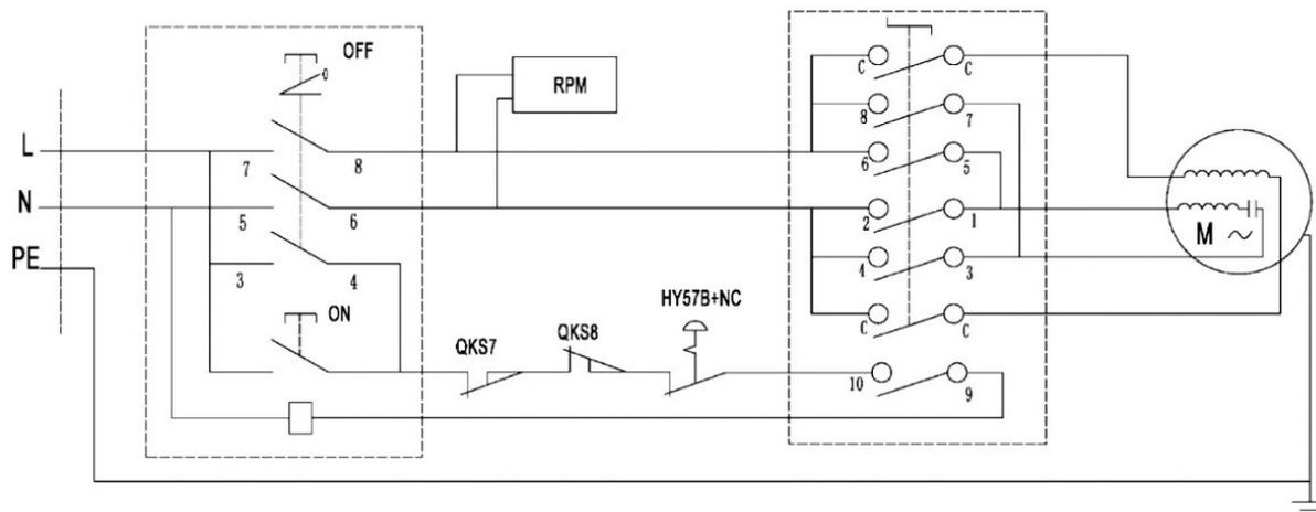
**Рисунок 2.** Электрическая схема (230В, 1 фаза)
