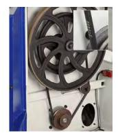
Клиновой ремень предназначен для установки на ленточнопильные станки BELMASH WBS-465, WBS-465/380.
