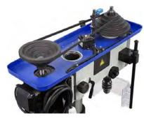
Ремень 530J имеет прочное и гибкое строение, состоящее из нескольких продольных ребер (поликлиновой профиль), что обеспечивает ему высокую прочность и долговечность. Используется на вертикальном сверлильно-резьбонарезном станке BELMASH MDTP510-16F/400.
