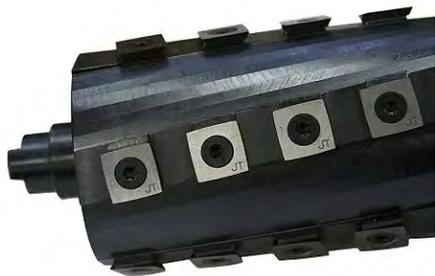
Вал строгальный Helical 260 оснащен 44 режущими пластинами, размещенными по спирали, за счет этого лезвия входят в заготовку последовательно и под углом, что снижает шум, вибрацию, ударные нагрузки и дает более чистый рез. Каждый сегмент имеет по четыре режущих кромки, что кратно увеличивает их ресурс: по мере необходимости лезвия переворачиваются или выборочно заменяются.
