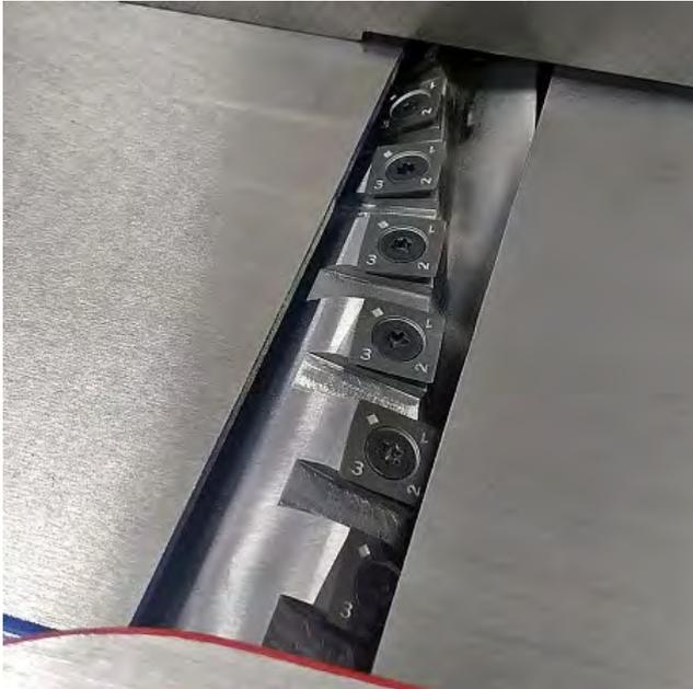
Вал строгальный Helical - предназначен для установки на фуговальный станок BELMASH J150/730АН
