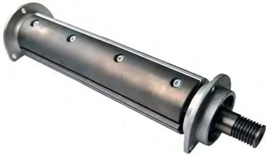
Вал строгальный для рейсмусовой приставки TD-2000. Выполнен из стали. На нем закреплены два сменных строгальных ножа длиной 200 мм. Каждое лезвие крепится к барабану четырьмя винтами М6.
