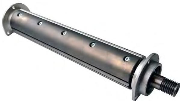
Вал строгальный BELMASH SDMR-270/3 - предназначен для деревообрабатывающего станка BELMASH SDMR-2500. Выполнен из стали. На нем закреплены 3 сменных строгальных ножа длиной 270 мм. Каждое лезвие крепится к барабану пятью винтами М6.
