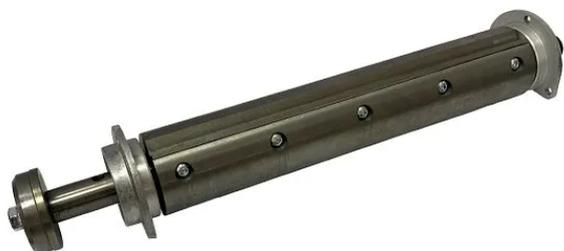
Вал строгальный BELMASH UN 2500E 270/2 - предназначен для деревообрабатывающих станков BELMASH UNIVESAL-2500E. Выполнен из стали. На нем закреплены 2 сменных строгальных ножа длиной 270 мм. Каждое лезвие крепится к барабану пятью винтами М6.
