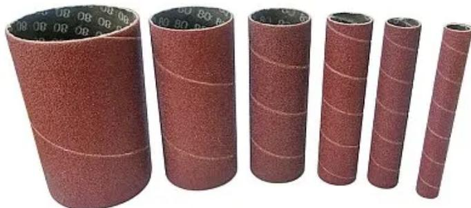
Набор втулок шлифовальных Р80-6 состоит из шести втулок диаметром 13/19/26/38/51/76 мм, с зернистостью абразива (электрокорунд) 80 grit. Применяется на станке шлифовальном осцилляционно-шпиндельном BELMASH OSS-115. Втулки имеют тканную основу с нанесением электрокорунда. Шов встык без притупления абразивного слоя. Втулки предназначены только для обработки древесины и древесных материалов. Не очищайте абразивные поверхности от пыли руками - используйте щетку или специальный чистящий карандаш.
