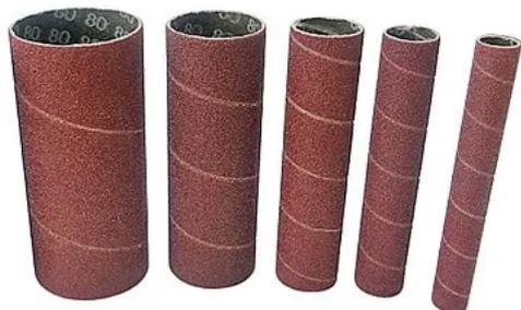
Набор втулок шлифовальных Р80-5 состоит из пяти втулок диаметром 13/19/26/38/51 мм, с зернистостью абразива (электрокорунд) 80 grit. Применяется на станке шлифовальном осцилляционном шпиндельноленточном BELMASH OSBS-100/115
