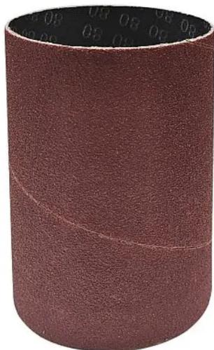
Втулка шлифовальная BELMASH 76\*115 мм P150 имеет диаметр 76 мм, с зернистостью абразива (электрокорунд нормальный) 150 grit. Применяется на осцилляционно-шпиндельном шлифовальном станке BELMASH OSS-115.
