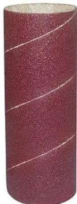
Втулка шлифовальная BELMASH 38\*115 мм P240 имеет диаметр 38 мм, с зернистостью абразива (электрокорунд нормальный) 240 grit. Применяется на шлифовальных станках: осцилляционном шпиндельно-ленточный BELMASH OSBS-100/115 и осцилляционно-шпиндельном BELMASH OSS-115.
