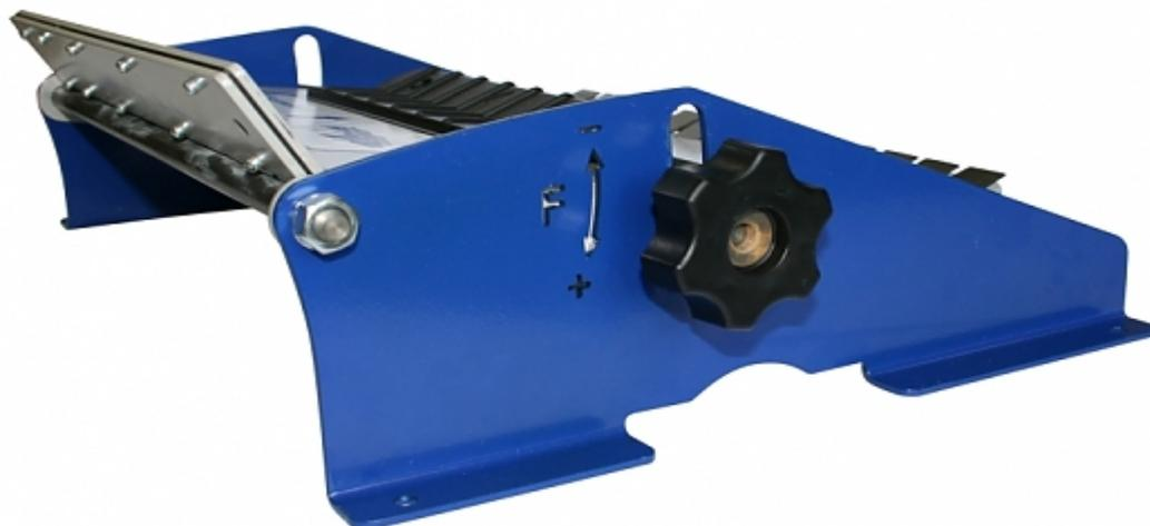
Устройства прижимные предназначены для безопасной обработки при строгании заготовок толщиной менее 60 мм. Выпускаются для всех моделей станков БЕЛМАШ. Обеспечивают равномерное прижатие заготовки к рабочей поверхности и облегчают подачу материала, что улучшает чистоту обработки заготовки.
